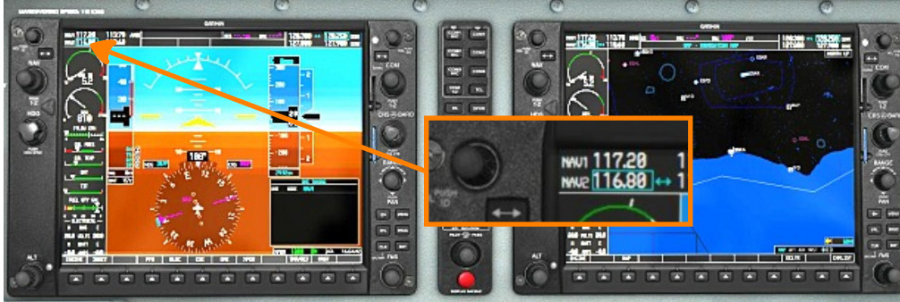
Glass cockpits hebben meestal een dual radio en de presentatie op het scherm is vaak makkelijker te begrijpen.
