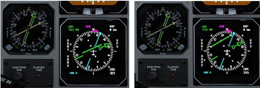
Links VOR1 en VOR2 op het scherm en rechts VOR2 + VOR2 (kan soms ook nut hebben) en zo zijn er vele mogelijkheden. De mooie HSI van de King Air 90.
