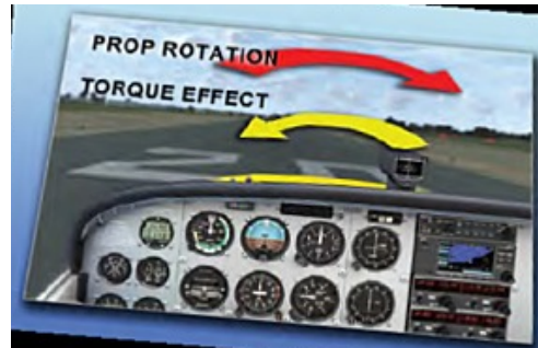
Het torque-effect van de propeller voegt nog een extra moeilijkheid toe aan het onder controle houden van propeller aangedreven vliegtuigen.
